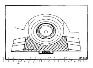
9. INSPECT SIDE SLIP WITH SIDE SLIP TESTER
